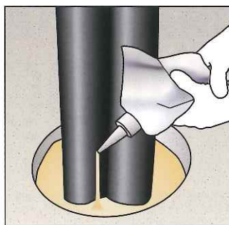
床下から電気室への湿気浸入防止
